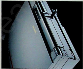
Das Diskettenlaufwerk kann gegen eine Slot-In Stromversorgung ausgetauscht werden.
